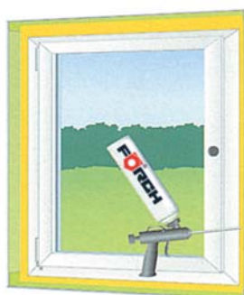
Bild 2: Fensterfuge mit Dämmmaterial (1K-PU-Schaum) ausschäumen.
