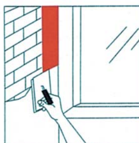
Bild 4: Die vlies-kaschierte Seite kann mit Mörtel überputzt bzw. Dispersionsfarbe überstrichen werden.
