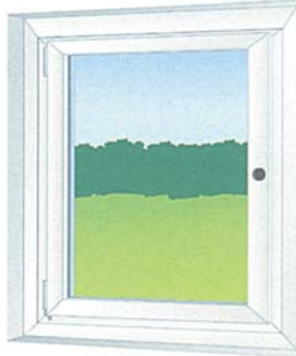
Bild 4: Die Anschlussfuge kann mit einer Flachleiste optisch abgedeckt werden.
