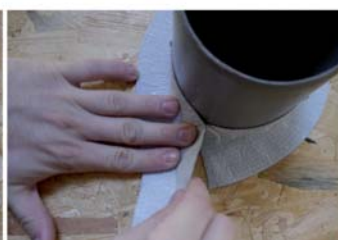
Klebebandende mit Klebebandanfang überlappen
